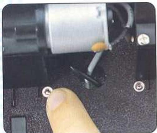
**2** Ora disponi la scheda di controllo del motore sul gruppo posteriore di inviti in rilievo situati sul lato superiore del telaio. Prendi una vite e inseriscila nel rilievo corrispondente al dado attraversando la scheda. Stringi la vite mantenendo in posizione il dado. Ripeti l'operazione con la seconda vite e il relativo dado. ▶
