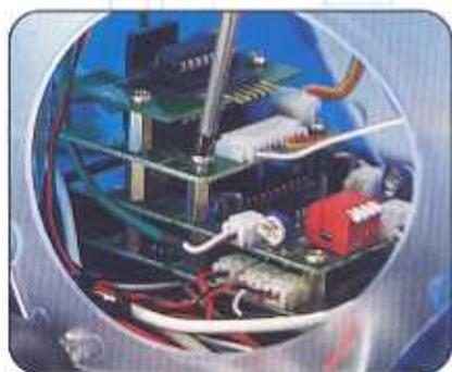
**1** Allenta le due viti che fissano la parte posteriore della scheda uC3 e mettile da parte in un posto sicuro. ▲▼
