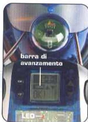
**7** Ora devi attendere: il trasferimento può richiedere alcuni minuti, durante i quali il LED rosso continua a lampeggiare sul telecomando e la barra di avanzamento a scorrere. Quando l'operazione è completata, sullo schermo appare la scritta OK! e il telecomando emette un bip. Premi ESC per tornare al menu principale. Togli il telecomando dalla docking station. ◀
