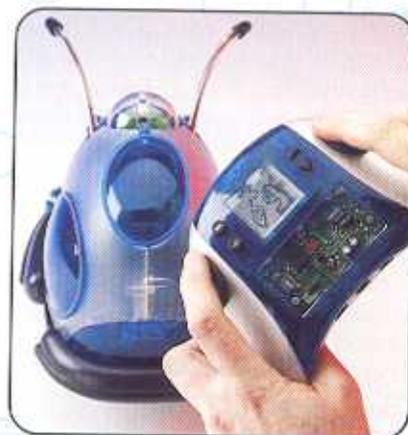
**Nota importante:** la comunicazione tra il telecomando e Cybot può avvenire sia direttamente dal trasmettitore IR dello stesso telecomando sia attraverso il trasmettitore IR della cuffia. Tuttavia, quando la cuffia è collegata, il trasmettitore del telecomando NON funziona, perciò in questo caso devi direzionare il trasmettitore della cuffia verso la cupola di Cybot. Quindi, quando indossi la cuffia, guarda in direzione di Cybot!
