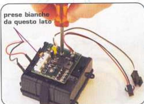
**2** Inserisci il connettore del vano batterie nella presa a tre pin sulla scheda. ▶
