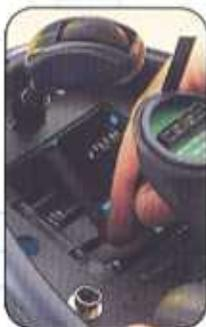
**2** Inserisci 8 pile AA da 1,5 V nel vano batterie. Assicurati che siano disposte correttamente, con i poli negativi (-) contro le molle. Rimonta il coperchio del vano batterie originale. ▶
