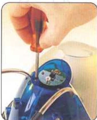
**5** Svita le due viti che fissano il pannello laterale destro al telaio e conservale in un posto sicuro. Solleva il pannello sfilando la linguetta posteriore e mettilo da parte. Ripeti l'operazione con il pannello laterale sinistro. ▶
