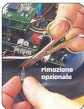
**2** La pila da 9 V non sarà più necessaria, puoi quindi rimuovere i cavi rosso e nero che passano sotto le schede e si connettono al vano batterie sottostante. Non è tuttavia possibile tirare il connettore nero e farlo passare attraverso il telaio, pertanto puoi semplicemente tagliarlo. Ma se desideri mantenere intatti i cavi, puoi svitare la scheda di controllo del motore e sconnetterla, riuscendo così a sfilare il connettore della pila. ◀
