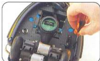
**3** Avvita la sezione del supporto superiore, con i suoi speaker, alle linguette dello scudo frontale utilizzando le viti originali. NON premere sulle linguette. ▶
