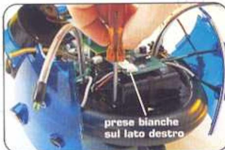
**4** Usando le quattro viti fornite, fissa il nuovo vano batterie al telaio. Assicurati che le prese bianche si trovino sul lato destro del robot. ◀
