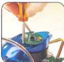
**4** Rimonta il pannello laterale sinistro. Assicurati che la linguetta posteriore s'inserisca nel pannello posteriore e le linguette anteriori nello scudo frontale. Fissalo al telaio con due delle viti originali. Ripeti l'operazione per il pannello laterale destro. Rimonta i tre pannelli flessibili e la cupola. ▶
