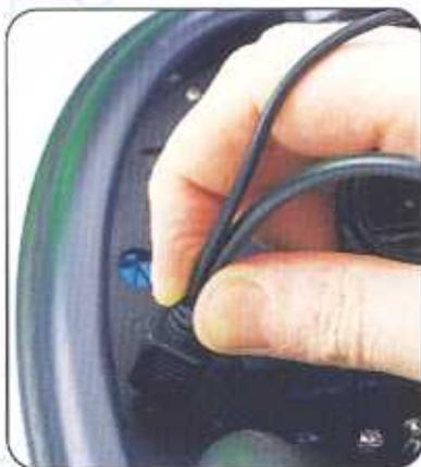
**2** Inserisci il connettore a 4 pin nella presa di alimentazione sulla parte inferiore del robot. *Nota:* il connettore può essere inserito in un solo modo, non forzarlo! ▲
