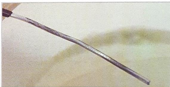
L'elettrodo negativo si annerisce e il positivo rimane del colore del rame.
