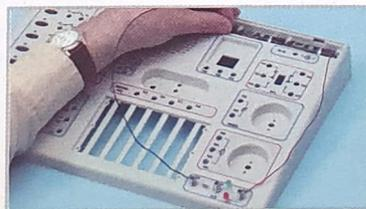
Il diodo LED si illumina meno quando la tensione accertata è minore (2 pile = 3 V).
