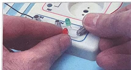
Dettaglio dell'incorporazione del LED rosso, che si illuminerà se si collega il rivelatore di polarità invertito.
