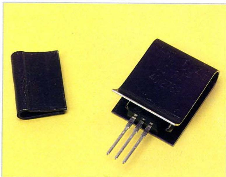
Quando non sia necessario dissipare una grande quantità di calore, si possono utilizzare dei dissipatori del tipo "a pinza", che hanno il vantaggio di essere velocemente installabili.
