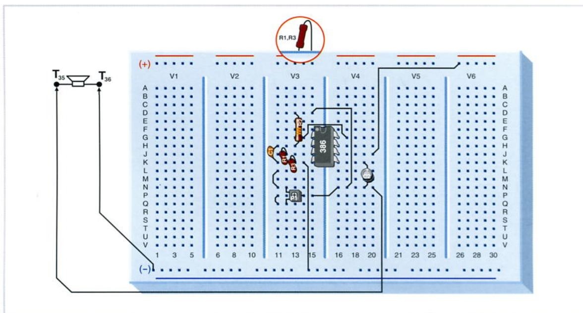
Il circuito ha un aspetto semplice, dato che utilizza un circuito amplificatore audio accoppiato ad un altro di controreazione. La potenza audio in uscita è elevata e la si può utilizzare in sistemi a cui viene richiesto un allarme sonoro molto potente.
