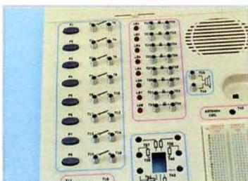
**6** Possiamo già verificare la collocazione della tastiera completa con tutte le sue molle di connessione.
