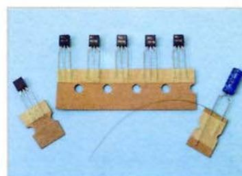
**8** Quando i componenti conservano resti di imballaggio ancora incollati, o anche solo di colla, si verificano dei problemi nelle connessioni; dobbiamo eliminarli prima di saldare i componenti o di inserirli.
