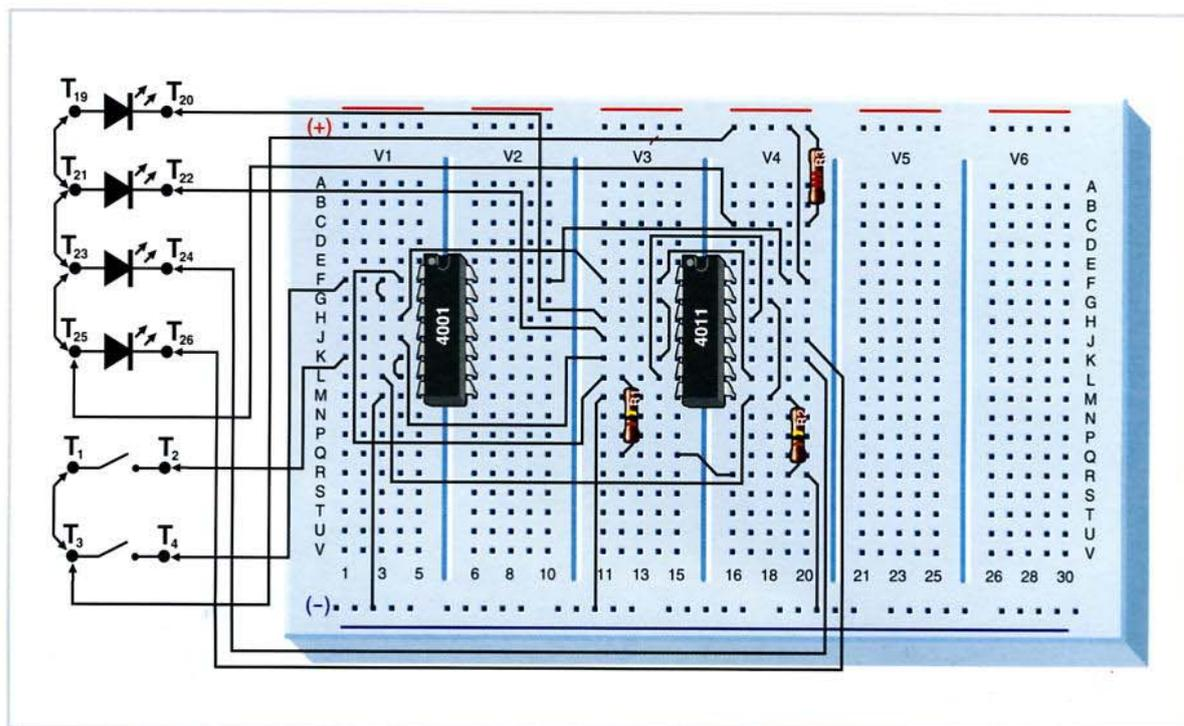
Il circuito ci consente, mediante due entrate digitali, di controllare all'uscita 4 diodi LED, di modo che il diodo LED che corrisponde al codice binario che si formerà all'entrata grazie ai pulsanti P1 e P2 si illuminerà. Il dispositivo che realizza questa funzione si chiama decodificatore da 2 a 4 linee.
