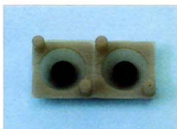
**7** Dettaglio interno di un tasto di riserva; la parte nera è di gomma nella cui composizione sono state disciolte delle particelle di materiale conduttore.
