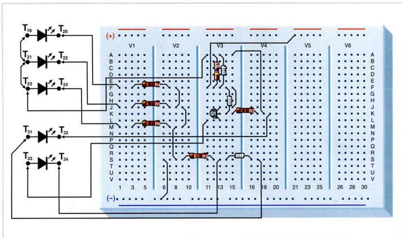
Il diodo LED LD8 si illumina quando il consumo dell'apparecchiatura è superiore a circa 12 mA. Il LED LD7 si accende quando c'è un'inversione di polarità all'entrata del circuito. In questo esperimento, la carica si sostituisce con tre diodi LED con le loro corrispondenti resistenze di polarizzazione. Se ne vengono scollegati uno o due, si ottengono consumi inferiori.
