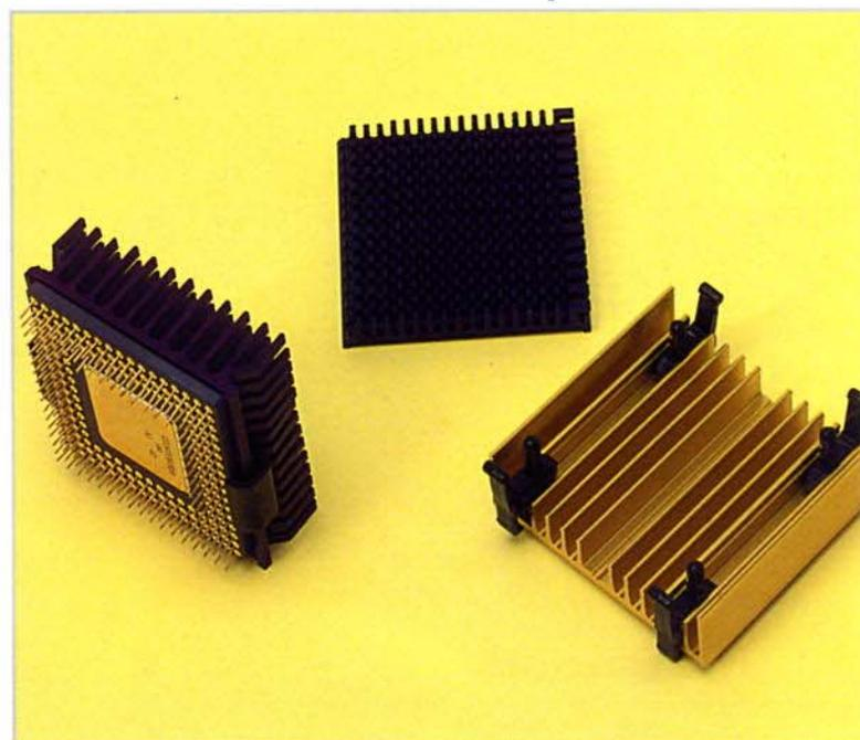
*Microprocessore 486 con dissipatore di calore.*
