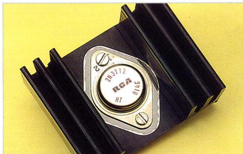
Tra il corpo del transistor, unito direttamente al collettore, e il radiatore, viene posta una lamina che isola dall'elettricità.
