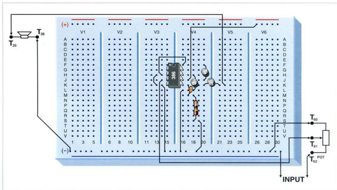
Il circuito integrato LM386 è stato progettato per la fabbricazione di amplificatori audio fino a 500 mW; possiamo alimentarlo con una tensione continua dai 4 ai 12 Volt. Quando è necessario un amplificatore audio, esso viene notevolmente utilizzato. Il potenziometro di controllo del volume consente di regolare il livello d'entrata.
