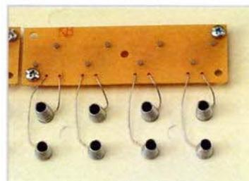
**5** Prima di andare avanti, bisogna rivedere tutte le connessioni dell'interno della tastiera, verificando che non esistano connessioni sbagliate.
