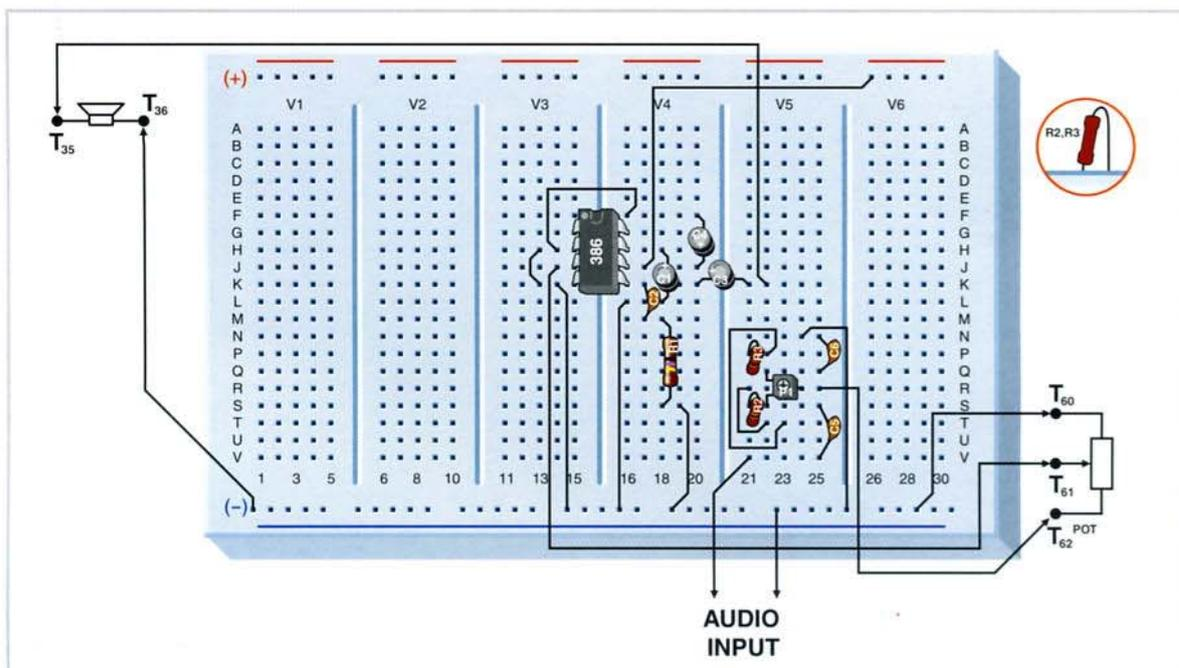
Questo circuito di controllo degli acuti è un "classico" nel suo campo e viene, quindi, molto utilizzato; inoltre, è passivo, non amplifica, e non ha bisogno di alimentazione. È costituito dai condensatori C5 e C6 e dalle resistenze R2 e R3, oltre che dal potenziometro P1.
