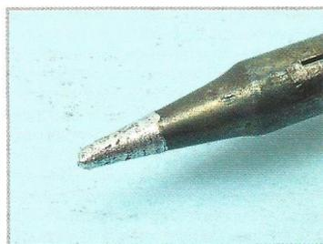
**7** La punta del saldatore, dopo la pulizia, brilla a causa dello stagno che ad essa aderisce, ma la sporcizia rimane attaccata alla spugna.
