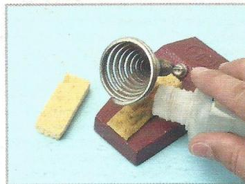
**5** La spugna che si usa per pulire la punta del saldatore deve essere ben inumidita con dell'acqua, così che non si bruci.
