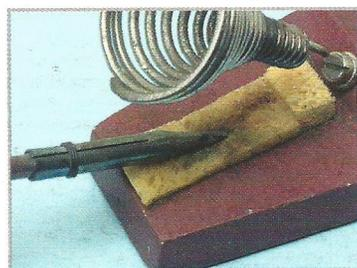
**6** La punta del saldatore va pulita con la spugna, non va mai limata perché si rovinerebbe lo strato di finitura superficiale.
