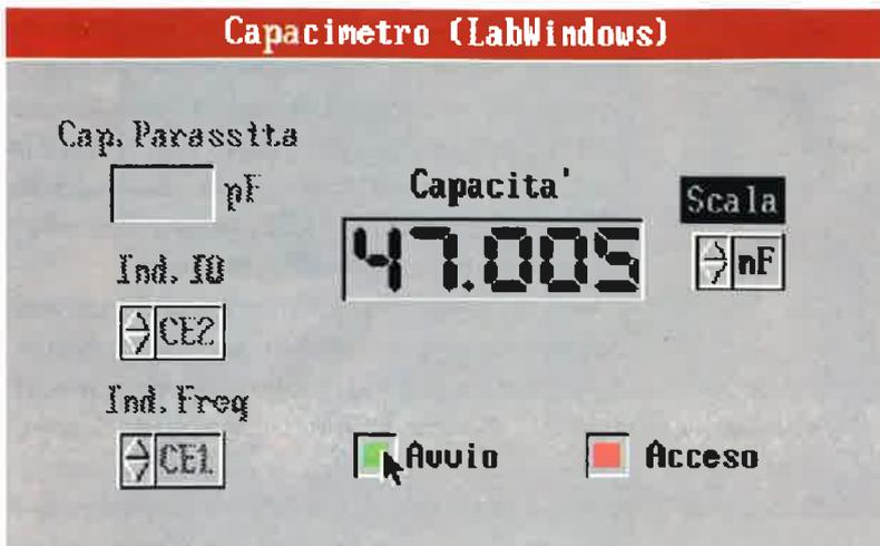
*Durante il normale processo di misura le finestre per l'impostazione degli indirizzi e del valore della capacità parassita rimangono disattivate*
