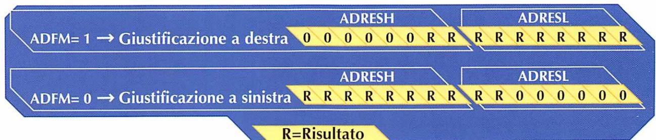
Funzionamento del bit ADFM nel registro ADCON1.
