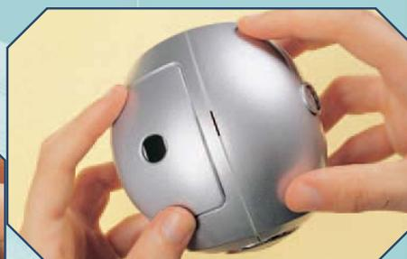
**4** Avvicina le due metà della testa, facendo attenzione che i fili rimangano tutti all'interno. Alla fine premi leggermente in modo da fissare la parte posteriore a quella anteriore.
