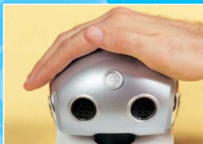
trova vicino al sensore: il corpo umano, ad esempio, genera una variazione piuttosto intensa. Il sensore di I-D01 è stato tarato proprio per rilevare una variazione di capacità riconducibile alla presenza del corpo umano.
