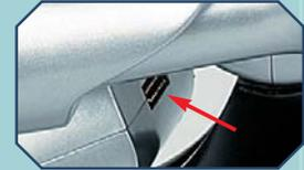
**1** La breadboard troverà posto sul coperchio per il vano delle batterie; consentirà di espandere la dotazione hardware del robot.
