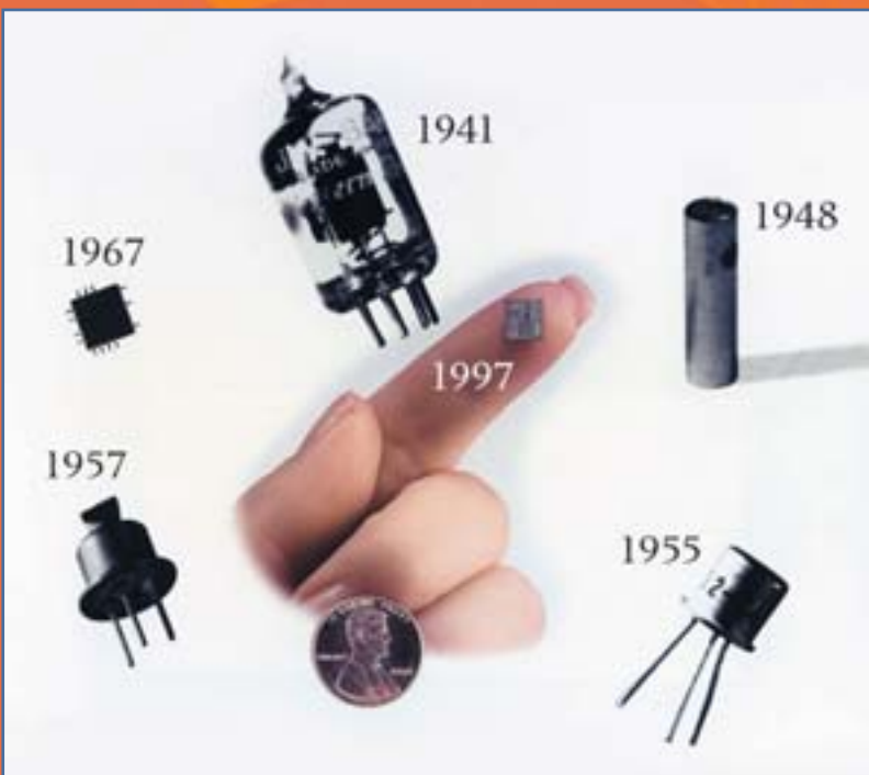
Sopra, un particolare della scheda Sound Follower sul quale sono evidenziati alcuni dei transistor di cui è dotata. A sinistra, una breve cronologia illustrata dei primi 50 anni dei transistor: uno dei loro precursori, i tubi elettronici dei primi anni quaranta del secolo scorso, un transistor 'a punto di contatto' del 1948, un amplificatore a transistor di metà anni cinquanta, un microchip del 1967 contenente due transistor, un chip di fine millennio in grado di contenere milioni di transistor.
