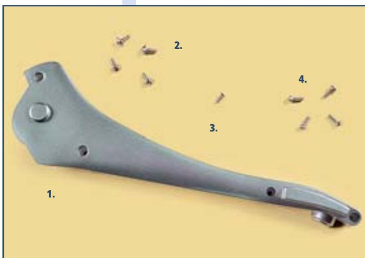
1. Parte destra del supporto per la ruota posteriore
