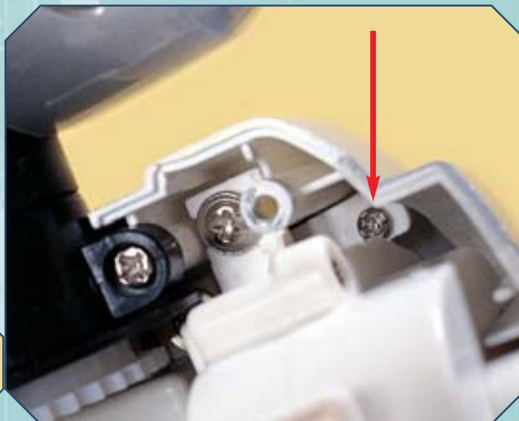
**6** Dopo aver riposizionato la testa (se l'avessi rimossa), usa la vite da 2,6x6 mm allegata a questo fascicolo per fissare il supporto del microfono (a destra).
