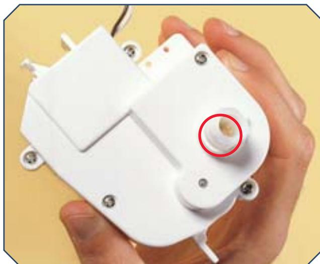
*Le scatole dei motori per le braccia di I-D01 presentano un albero di movimento che mostra una protuberanza (sopra). Essa deve essere rivolta verso il retro del robot per la scatola sinistra (sotto) e verso avanti per la destra (sotto a destra).*
