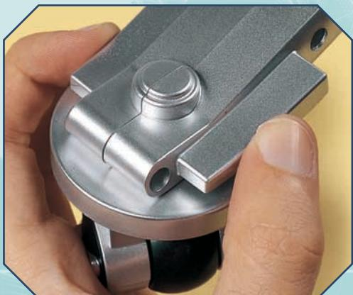
**7** Componi le due parti del supporto, facendo pressione sull'estremità dove è alloggiata la ruota posteriore (a sinistra) e sull'estremità opposta (a destra). Poi fissa le due parti serrando le quattro viti da 3,8x8 mm indicate al fascicolo 34 negli appositi fori della parte destra (qui a sinistra ne sono mostrati due).
