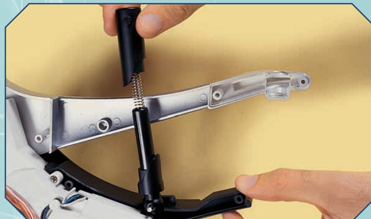
**3** Avvicina il cilindro al pistone comprimendo la molla, poi inserisci la sporgenza dell'estremità del cilindro nell'apposita sede della parte sinistra del supporto per la ruota posteriore (sotto).
