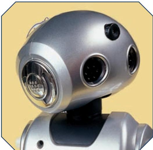
*Come al solito, durante la procedura di inizializzazione la testa del robot si sposta verso l'alto e il basso, poi a sinistra fino a fine corsa (immagine qui a lato) e a destra fino alla posizione centrale. Terminato il caricamento dell'OS, è possibile utilizzare il nuovo menu del display, navigabile utilizzando i tasti sul torso di I-D01 (immagine sotto).*
