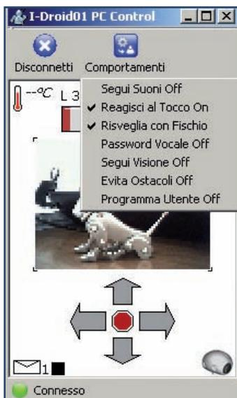
'ponte di collegamento'. L'unica accortezza da ricordare è quella di avviare il software di controllo per PC e di connetterlo a I-D01 prima di lanciare il trasferimento del programma a bordo del robot. A tal proposito, va rimarcato che le versioni precedenti alla 1.3.1 (come quella inclusa nel primo CD) non possono fungere da tramite tra il Visual C-like Editor e I-Droid01.
