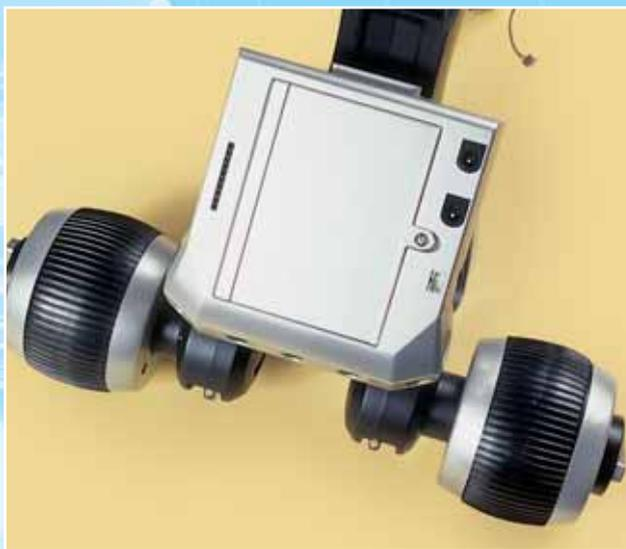
*Con il montaggio delle due ruote anteriori, la base del robot (sopra in un'immagine d'insieme) è completa dal punto di vista meccanico, anche se per essere utilizzata da I-D01 dovrà essere collegata alla scheda elettronica del modulo Base. Quest'ultima ne controllerà le funzioni, rendendole accessibili da parte del modulo Brain & Vision e, di conseguenza, anche dei software di controllo e di programmazione.*
