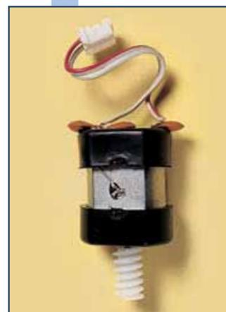
1. Motore elettrico per la pinza
