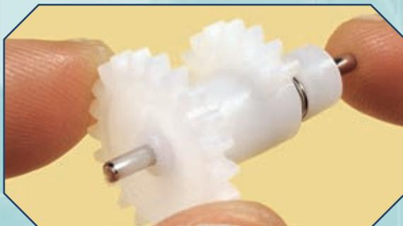
**1** Prendi ora l'albero con elementi dentati (sopra) e ponilo nel foro indicato a destra, in modo che la semiruota sia orientata verso l'esterno della struttura.
