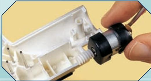
**3** Prendi adesso il motore, allegato al fascicolo 78. Avvicinalo alla parte superiore della struttura (sopra) e poi inseriscilo nella sua sede (a destra), premendolo per posizionarlo bene.
