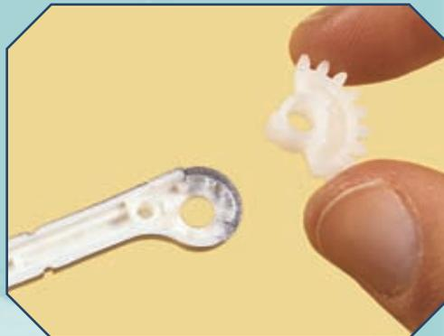
**3** Poni la semiruota dentata sull'estremità forata della metà del dito, facendo in modo che i due pezzi combacino. Presta attenzione nel posizionamento: le facce della semiruota sono differenti tra loro.
