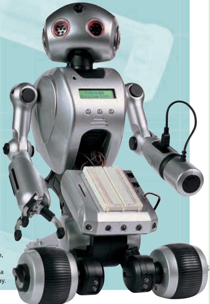
**12** Il montaggio è infine completo. I-Droid01 (a destra) è ora dotato di pinza (braccio destro) e di telecomando universale (braccio sinistro). Per utilizzare il telecomando è necessario il suo addestramento, realizzabile tramite la programmazione, con i software di controllo o attraverso la procedura Voice learning, attivabile con il menu del display.
