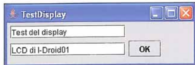
Sopra, il pannello di gestione del display, con i due campi per la scrittura dei messaggi e il pulsante di conferma. Sotto a sinistra, il prompt con il lancio dell'esecuzione.
