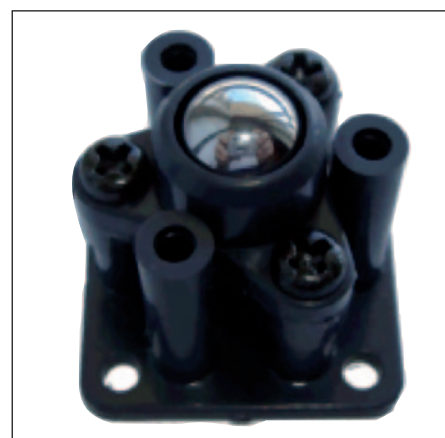
Figura 7: la sfera, terzo punto di appoggio del robot.
