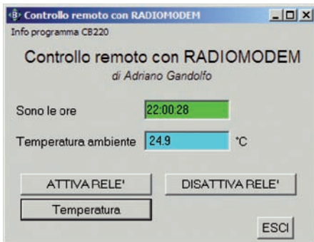
Figura 26: schermata del programma di controllo su PC.
