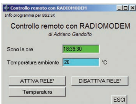
Figura 23: schermata del programma di controllo su PC.
