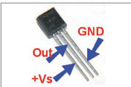
Figura 15: piedinatura del sensore.
