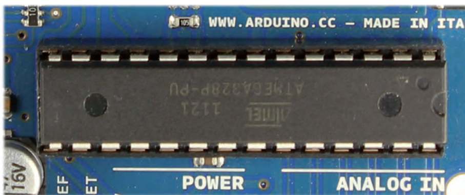
Figura 5: dettaglio sezione processore ATmega328.
