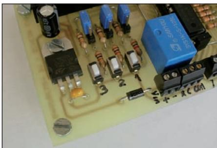
Figura 11: sezione di alimentazione.
