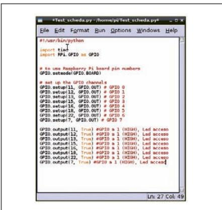
Figura 32: programma di test.
