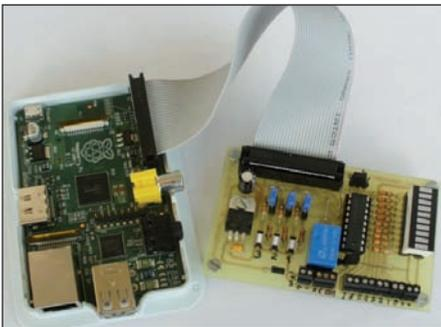
Figura 29: collegamento delle schede.
