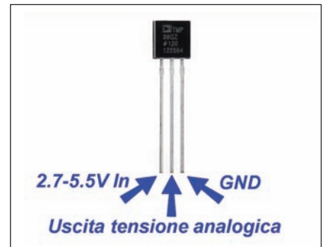
Figura 17: piedinatura del sensore TMP36.
