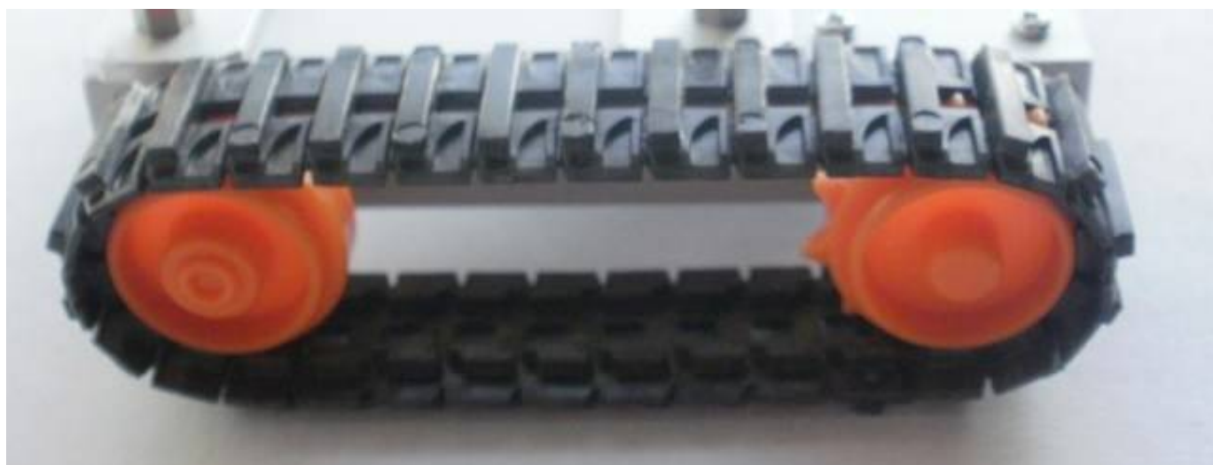
Vista del cingolo a montaggio avvenuto
