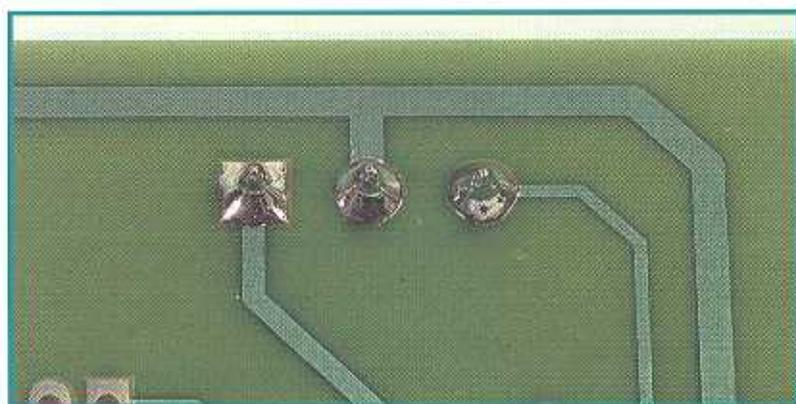
Nell'immagine si possono vedere le saldature realizzate sulla morsettiere. È necessario utilizzare più stagno rispetto alle saldature del resto dei componenti elettronici della scheda. Dobbiamo ottenere dei coni brillanti e appoggiati sulla superficie.
