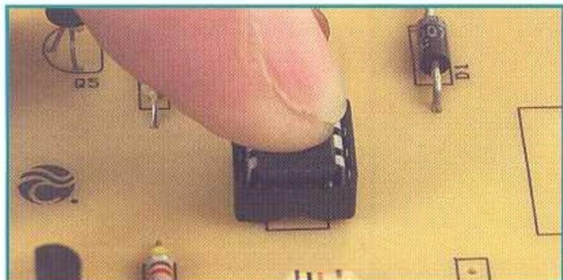
Inseriremo il circuito integrato nello zoccolo sino a che sarà totalmente introdotto, come si vede nell'immagine. Altrimenti, il chip non farebbe un buon contatto e con il passare del tempo potrebbe provocare un malfunzionamento.
