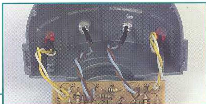
Una volta realizzata la connessione precedente, lo stampato viene introdotto nelle guide interne della testa. I cavi devono essere piegati con cura perché rimangano alloggiati in questa metà della testa di Monty e non diano fastidio in seguito.
