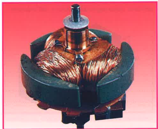
Interno di un motore a corrente continua. Osserviamo gli avvolgimenti del rotore.
