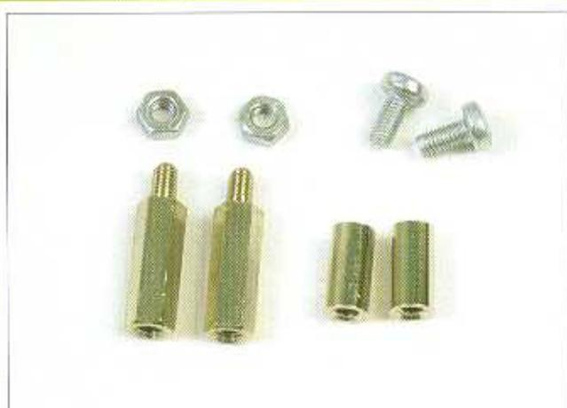
**1** Dopo aver terminato il montaggio elettronico della prima delle schede di controllo di Pathfinder, montiamo dei separatori che ci permetteranno di fissare la scheda sul telaio, oltre che a costituire una base su cui montare le altre schede elettroniche.
