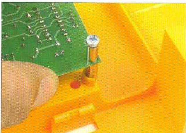
**8** Questo è il modo di introdurre la scheda sul telaio. Viene montata nella zona centrale del telaio, nei quattro alloggiamenti predisposti per i separatori. I separatori esagonali che abbiamo montato nella scheda devono entrare in questi alloggiamenti come mostra l'immagine.
