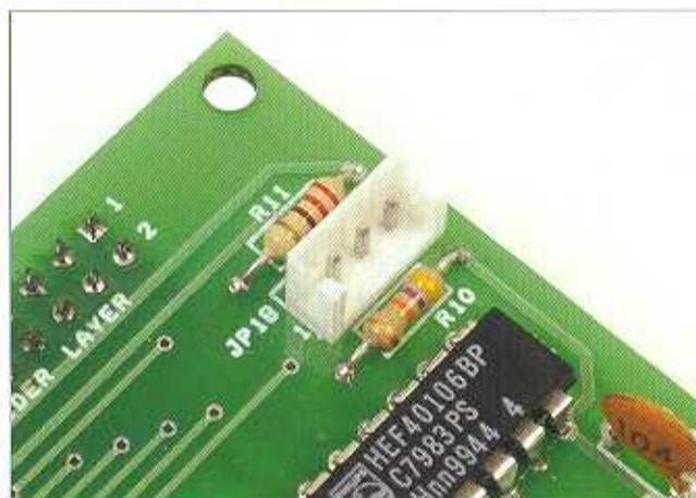
**7** Dobbiamo montare e saldare un altro connettore maschio, dritto, da tre pin nella posizione JP18 della scheda. Il verso d'inserzione del connettore è indicato dalla doppia linea bianca disegnata sulla serigrafia della scheda, che dobbiamo far coincidere con il lato senza parete del connettore.
