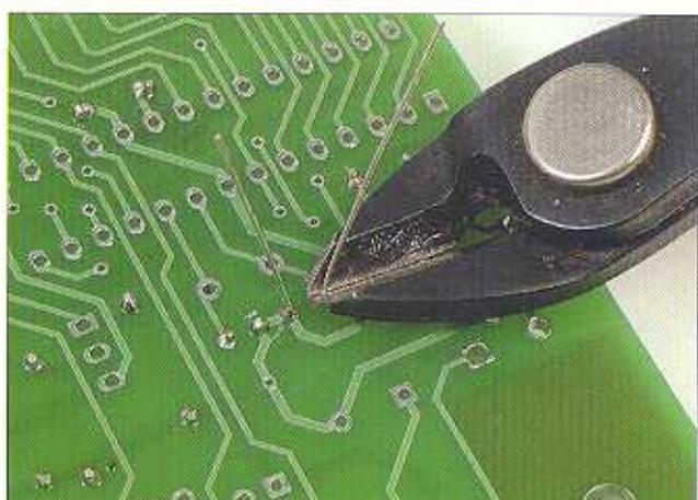
**4** Salderemo i condensatori con la stessa tecnica del condensatore C9, riscaldando la zona da saldare e avvicinando ai lati opposti dei piedini del condensatore saldatore e stagno. Dopo aver realizzato le saldature, utilizzeremo un tronchesino o un paio di forbici per tagliare la parte eccedente del reoforo.
