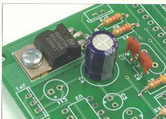
**4** In questa immagine si mostra il condensatore C6, da 470 µF, correttamente inserito. Il verso d'inserzione deve essere quello mostrato nell'immagine, dato che un posizionamento errato provocherebbe un mal funzionamento della scheda. Una volta inserito lo salderemo, seguendo la stessa procedura utilizzata per gli altri componenti.
