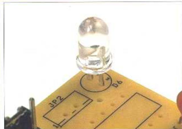
**4** Nell'immagine possiamo vedere il fototransistor correttamente montato sulla scheda. Non deve rimanere completamente a filo della scheda, ma elevato di qualche millimetro dalla superficie della stessa.
