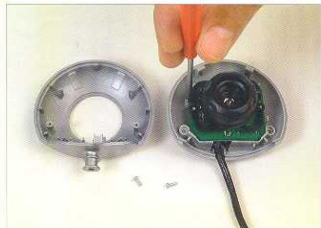
**3** Ora possiamo vedere l'interno della telecamera Web, ma il nostro scopo è arrivare al suo connettore, quindi continueremo a smontarla. Sviteremo ed estrarremo le due viti interne che fissano il circuito stampato contenente l'elettronica della telecamera Web.
