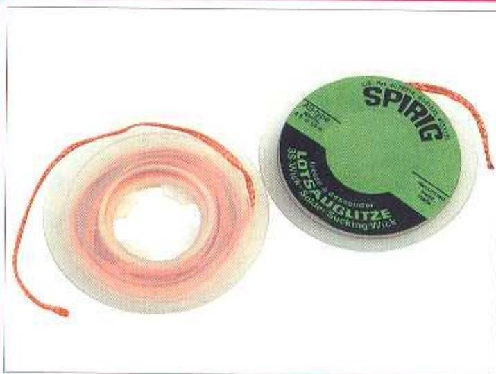
Conosciamo già il procedimento per realizzare la saldatura; dobbiamo però imparare anche a dissaldare, per poter togliere un componente dalla scheda nel caso in cui sia stato saldato male o sia rovinato. Ci sono diversi strumenti per realizzare la dissaldatura, nell'immagine si mostra un elemento molto semplice per dissaldare, si chiama treccia dissaldante. Si tratta di una calza di rame che al contatto con lo stagno fuso lo fa aderire alla sua superficie togliendolo dalla scheda.
