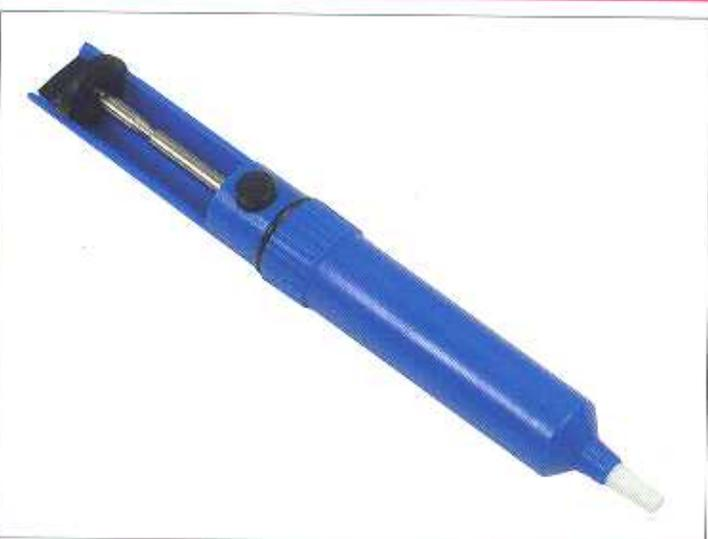
Questo dissaldatore è molto comune, è chiamato dissaldatore a vuoto o succhiastagno. È composto da un cilindro che ha al suo interno un pistone che si aziona mediante una molla. Il suo effetto d'assorbimento è basato sulla pressione esercitata dalla molla. Possiede una punta di teflon che sopporta le temperature utilizzate nella saldatura. Di seguito spiegheremo il procedimento per realizzare una dissaldatura utilizzando questo strumento.
