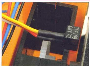
Gli altri due sensori ottici servono per il movimento delle gambe laterali, che hanno il compito di far avanzare il robot. È necessario sapere quando le gambe arrivano al loro limite, sia in avanti sia indietro, per poter elaborare la sequenza adeguata, corrispondente al movimento del robot nelle quattro direzioni. Per questo abbiamo a disposizione i sensori ottici che inviano un segnale al microcontroller quando si avvicinano le parti meccaniche.
