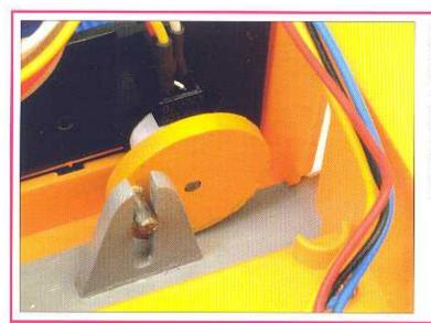
Il primo sensore ottico servirà per controllare il movimento delle due gambe centrali del robot. Queste gambe sono quelle che permettono al robot di realizzare un movimento basculante su entrambi i lati, in modo che le altre gambe si possano muovere liberamente e avanzare. Questo sensore rileva il pezzo meccanico mostrato nell'immagine, e invia dei segnali al microcontroller, utili per conoscere la posizione delle gambe in ogni momento.
