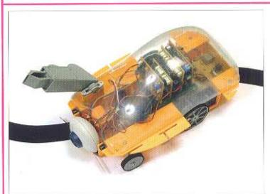
Per fare in modo che il robot possa seguire una traiettoria sul pavimento, è necessario che disponga di due sensori, dato che se ce ne fosse uno solo, potremmo sapere quando esce dal percorso, ma non se è uscito da destra oppure da sinistra. Mediante i due sensori, in funzione di quale dei due invierà il segnale che il robot è uscito dalla traiettoria, attiveremo i motori per fare in modo che giri sino a correggere la sua direzione.
