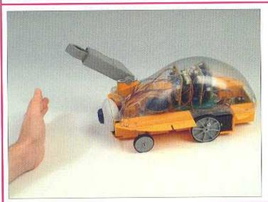
L'elettronica di Pathfinder permetterà anche di rilevare il movimento. Grazie a questa funzione, quando un oggetto mobile o una persona passa davanti al robot, verrà inviato un segnale al microcontroller per avvisarlo del fatto. Sarà anche possibile modificare il campo di rilevazione di movimento da assegnare al robot, da pochi centimetri sino a circa due metri.
