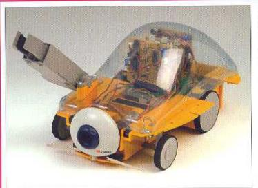
Grazie alle funzionalità aggiunte dai sensori a ultrasuoni, potremo implementare diverse applicazioni con Pathfinder. Ad esempio potremo programmare il robot per farlo funzionare come pattugliatore del terreno, e farlo avanzare senza la necessità di lasciarlo entrare in contatto con gli ostacoli, oppure per farlo funzionare come guardia di sicurezza, che si attivi quando rileva del movimento o qualche presenza estranea davanti a sé.
