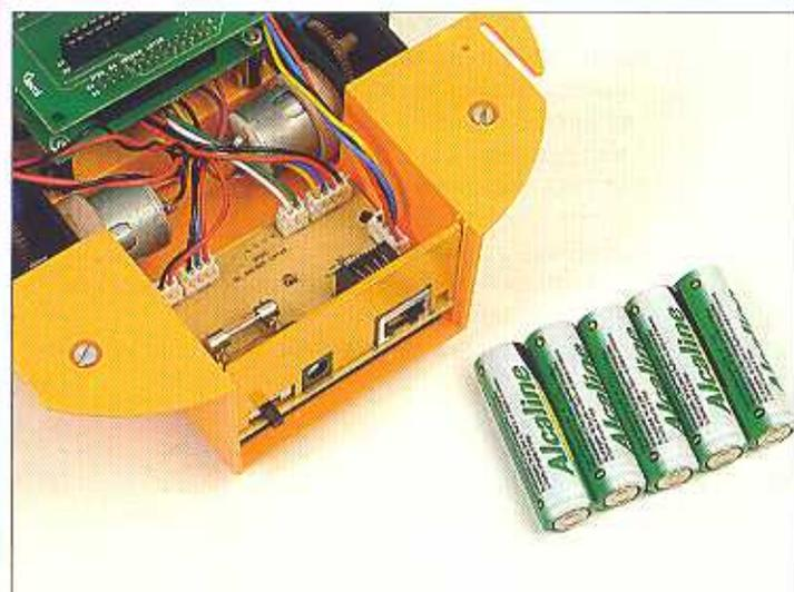
Quando lavoriamo con i motori di Pathfinder, è consigliabile non alimentare il robot con una tensione superiore a 7,5 V. La scheda di potenza può gestire tensioni superiori, però i motori avrebbero una coppia di avanzamento tale per cui si potrebbe danneggiare la meccanica del robot. La tensione ottimale di funzionamento per i motori, si ottiene con cinque pile inserite nel portabatterie di Pathfinder.
