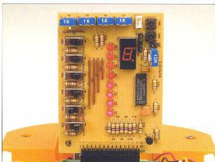
Per verificare l'esercizio, modificheremo lo stato degli interruttori SW3 (RC0) e SW4 (RC1). Ogni volta che realizzeremo un ciclo 0-1-0, mediante SW3, inseriremo un impulso, e il contatore aumenterà o diminuirà il suo valore binario in funzione dello stato dell'interruttore SW4, che invia segnali al pin RC1 del microcontroller.
