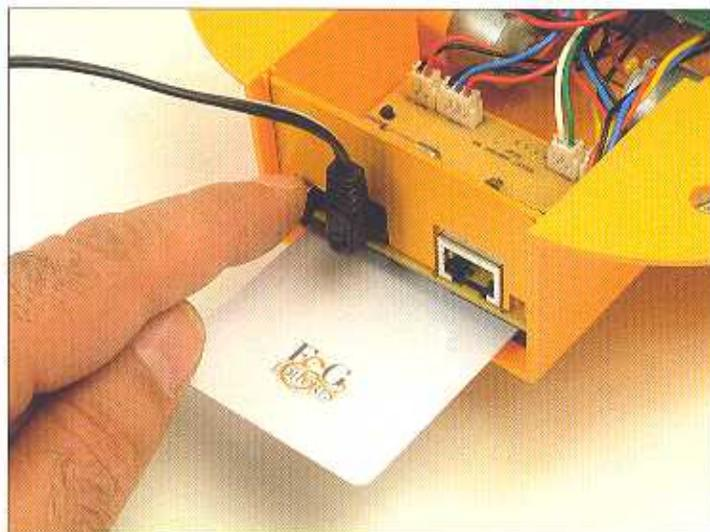
Quando la scheda sarà stata programmata, la inseriremo sulla scheda di alimentazione del robot. Per realizzare questi esercizi di apprendimento vi consigliamo di alimentare il robot con un alimentatore a corrente continua tramite connettore J1 della scheda di alimentazione. La scheda di ingressi e uscite deve essere inserita sulla scheda di interfaccia, e il microcontroller dovrà essere presente sulla scheda di controllo con il programma uploader caricato.
