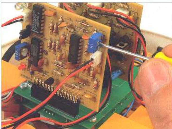
Il potenziometro R8 della scheda a ultrasuoni permette di regolare la distanza di rilevamento; possiamo ruotare il potenziometro a destra o a sinistra per verificare le soglie massime e minime di rilevazione di movimento dei sensori a ultrasuoni. Per ruotare il potenziometro utilizzeremo un piccolo cacciavite a taglio.
