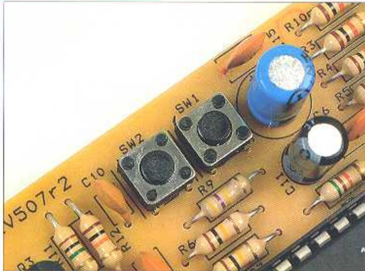
Continuiamo l'analisi della scheda audio. Nell'immagine possiamo vedere i due pulsanti di cui dispone la scheda. Tramite questi pulsanti inseriremo i messaggi da scrivere nel robot e potremo ascoltare la loro riproduzione in modo manuale. Quando ascolteremo i messaggi in modo manuale, verranno riprodotti in modo continuo i secondi di scrittura che sono stati memorizzati sul chip ISD1416.
