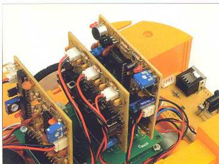
Come possiamo vedere nell'immagine, il sensore a infrarossi è posizionato sulla zona superiore della scheda in modo da poter captare i segnali a infrarossi che arrivano da qualsiasi telecomando. Nella zona superiore della scheda si trova anche il microfono. Ricordiamo che il microfono ha due funzioni: serve per inserire i messaggi che verranno successivamente riprodotti dal robot e per captare il suono ambientale che verrà riprodotto tramite gli altoparlanti del PC.
