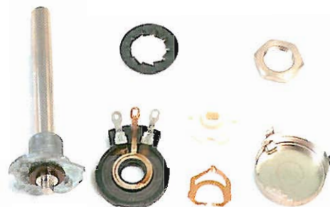
Pezzi di un potenziometro da pannello.
