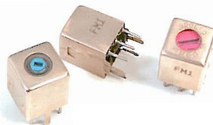
Trasformatori per RF; sono coperti da un involucro di metallo.
