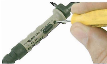
Regolazione dell'attenuatore della sonda di un oscilloscopio.
