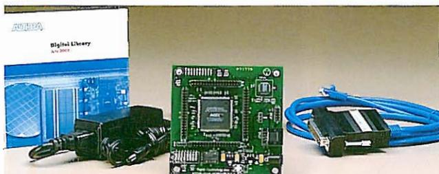
Kit di sviluppo basato su FPGA ad architettura ACEX di Altera.
