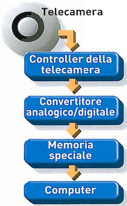
I sistemi di visione sono composti da una telecamera che cattura le immagini che saranno trasferite al computer con il quale essa sta comunicando.
