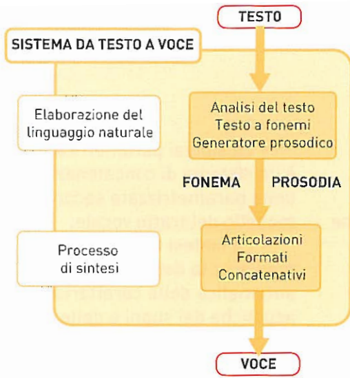
Semplice diagramma funzionale di un sistema TTS.
