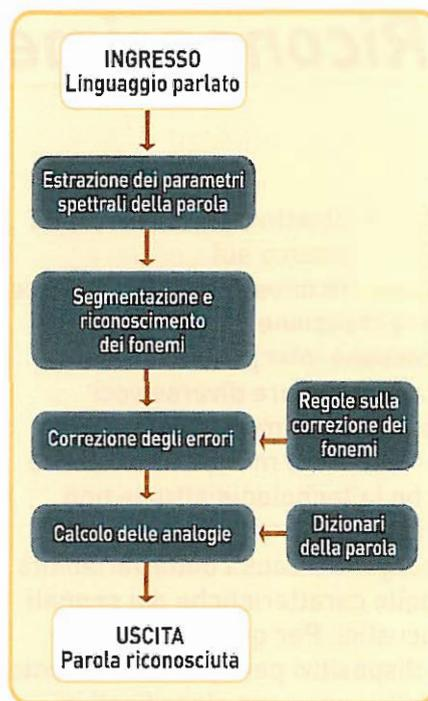
**Schema del funzionamento di un sistema di riconoscimento della voce.**
