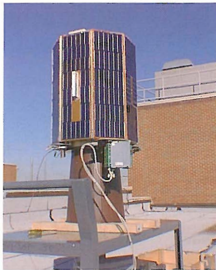
Esempio di un radiofaro omnidirezionale in fase di costruzione.
